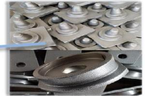
转向结构采用平面压力轴承和锥形轴承，高承载，抗冲击，转向灵活。
